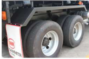
บึงโคลนหลัง 10 ล้อ (ซ้าย) 420000010039
